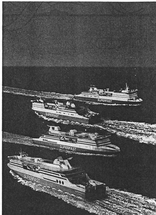
会社が、ドイツの造船所で建造したもので、総トン数が23,663トン、34550kWの主機で28ノットという船である。同型船が95年に1隻建造され、2隻での高速サービスが開始された。これに対して、同航路の最大手であったミノアン・ラインは23ノットの大型豪華カーフェリーを建造して対抗したものの、利用者のニーズは高速船の方にあった。「スーパーファーストⅠ」「同Ⅱ」は多くの利用者に歓迎され、大成功を収めた。
